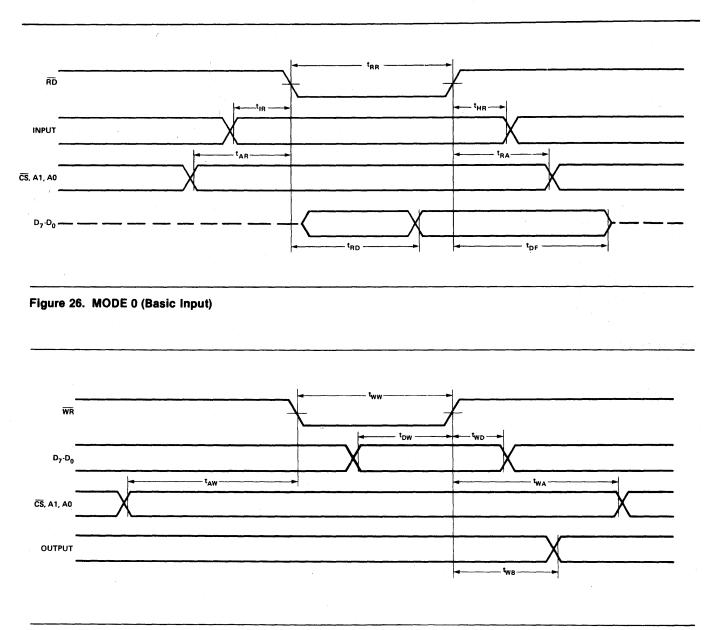
Figure 27. MODE 0 (Basic Output)
