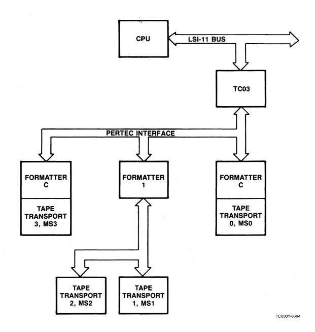
Figure 4-6. TC03 Formatted/Streaming Combination Subsystem
