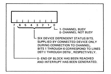
Figure 4-4. DMA Status Byte Format
