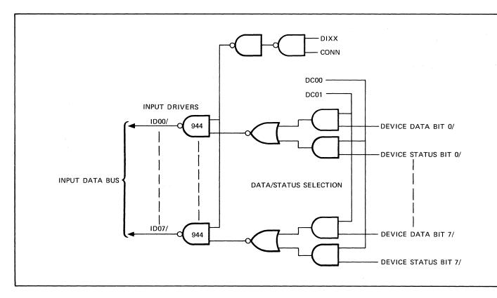
Figure 3-8. Status Input Logic
