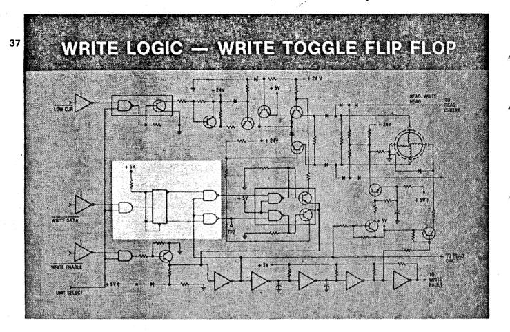
THE WRITE TOGGLE FLIP FLOP IS THE FIRST STAGE IN CONVERSION OF THE COM-POSITE CLOCK AND DATA BIT SERIAL DATA SIGNAL FROM THE HOST SYSTEM CON-TROLLER TO THE SIGNAL USED BY THE WRITE HEAD.
