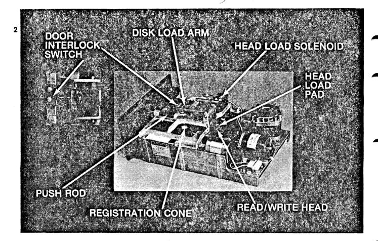
THE PICTURE SHOWS A B 9489-5 UNIT, REMOVED FROM THE HOST SYSTEM AND IDEN-TIFIES SOME OF THE MAJOR SUBASSEMBLIES. CLOSING THE DOOR MOVES THE PUSHROD WHICH ENGAGES THE DISK LOAD ARM. THE DISK LOAD ARM MOVES THE REGISTRATION CONE TO CLAMP THE DISKETTE TO THE SPINDLE.
