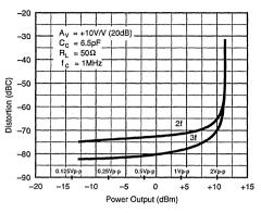
10MHz HARMONIC DISTORTION vs POWER OUTPUT
