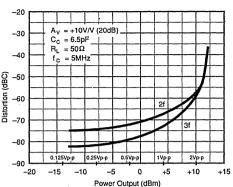
20MHz HARMONIC DISTORTION vs POWER OUTPUT
