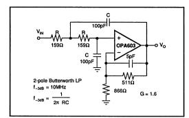
FIGURE 8. Low-Pass Filter - 10MHz.
