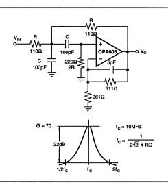
FIGURE 10. Bandpass Filter - 10MHz.
