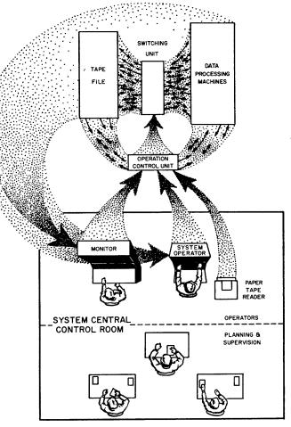
Fig. 2-System Central diagram.
