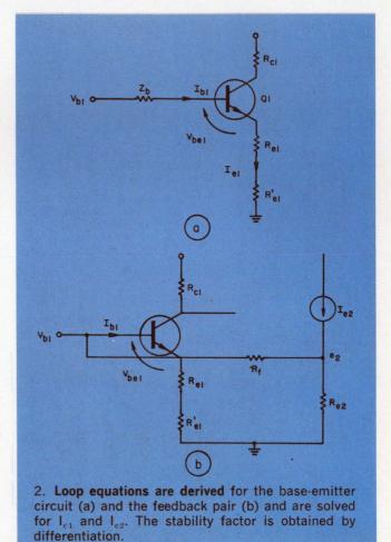
$$R_{e2} I_{e2} = (R_f + R_{e2}) I_{b1} + V_{be1} + (R_{e1} + R'_{e1}) I_{e1}.$$
