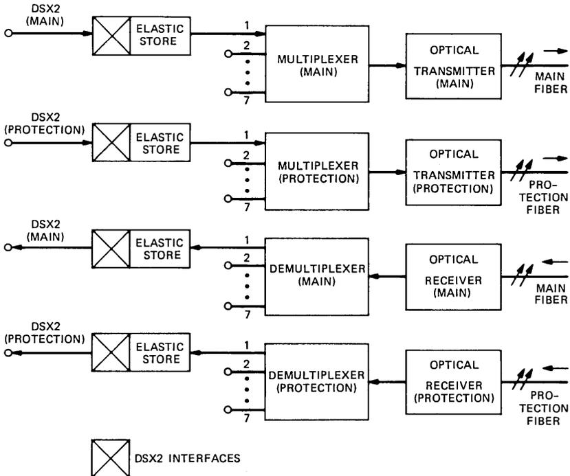
Fig. 17—Block diagram of DS2/DS3 multiplexer.
