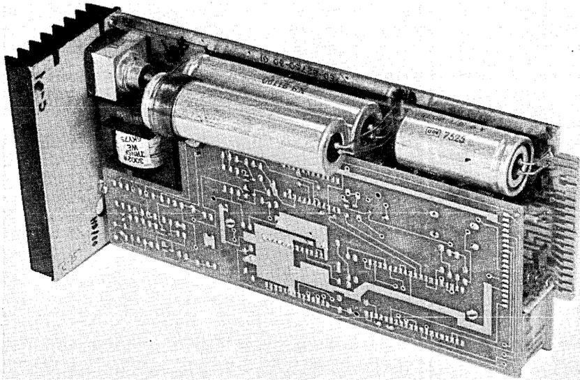
Fig. 4—Voltage converter.
