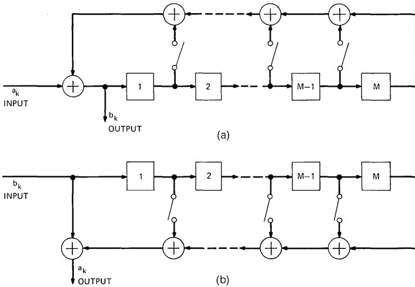
Fig. 2—(a)  $M$ -stage scrambler. (b)  $M$ -stage descrambler.
