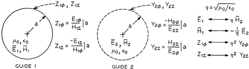
Fig. 2—Dual waveguides.
