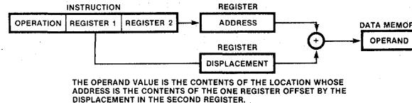
THE OPERAND VALUE IS THE CONTENTS OF THE LOCATION WHOSE ADDRESS IS THE CONTENTS OF THE ONE REGISTER OFFSET BY THE DISPLACEMENT IN THE SECOND REGISTER.
