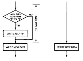
a) PRECONDITIONED DATA BEFORE WRITE b) RANDOM DATA BEFORE WRITE
