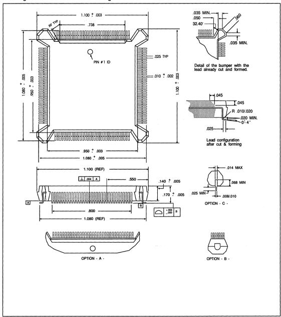
**FIGURE 27. 132-PIN JEDEC PACKAGE**
