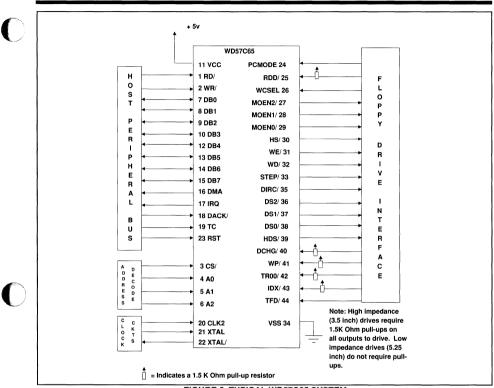
FIGURE 6. TYPICAL WD57C65 SYSTEM
