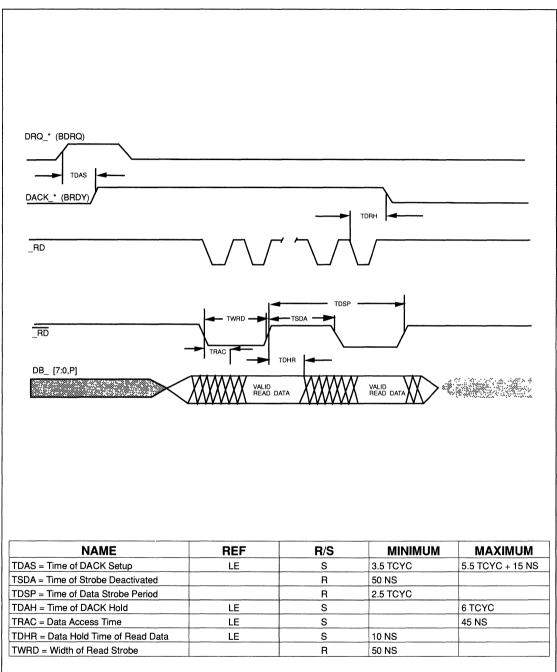
FIGURE 14-8. SLAVE BURST DISK MODE (READ)
