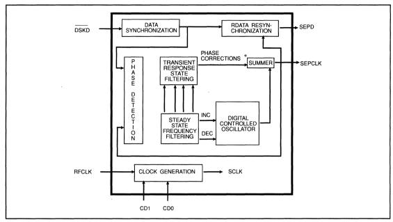
FIGURE 2-3. WD92C32 SIMPLIFIED BLOCK DIAGRAM
