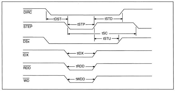
FIGURE 5-6. DISK DRIVE TIMING
