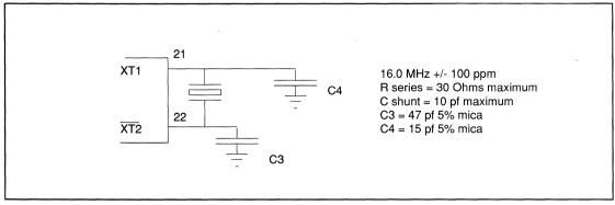
FIGURE 2-1. XTAL OSCILLATOR CIRCUITS FOR THE 44-PIN PLCC
