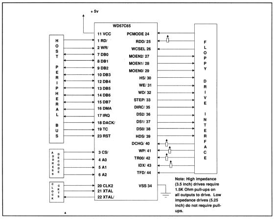
FIGURE 3-3. TYPICAL WD57C65 SYSTEM
