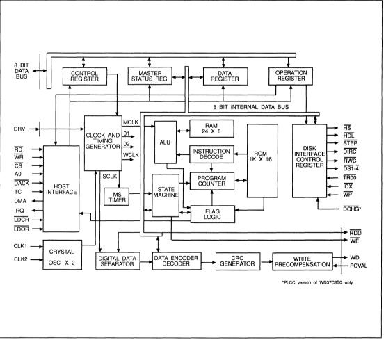
FIGURE 3-1. WD37C65C BLOCK DIAGRAM
