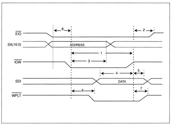
FIGURE C-1. I/O WRITE-AT MODE
