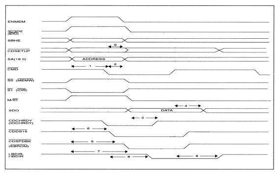
FIGURE C-8. MEMORY READ-MICRO CHANNEL MODE
