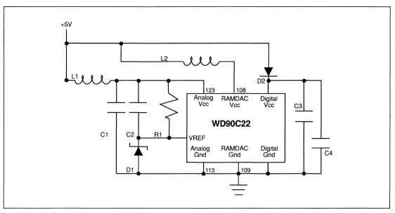
FIGURE 4-2. POWER DISTRIBUTION FOR WD90C22
