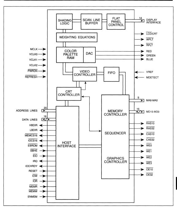
FIGURE 2-1. WD90C22 BLOCK DIAGRAM
