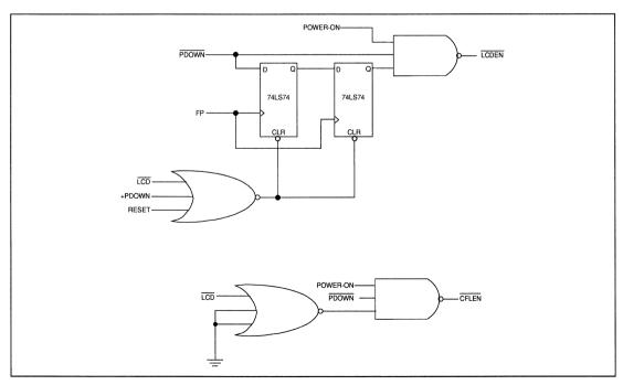
FIGURE 8-1. LCD PANEL CONTROL
