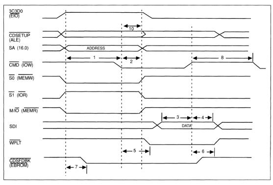
FIGURE C-5. I/O WRITE-MICRO CHANNEL MODE
