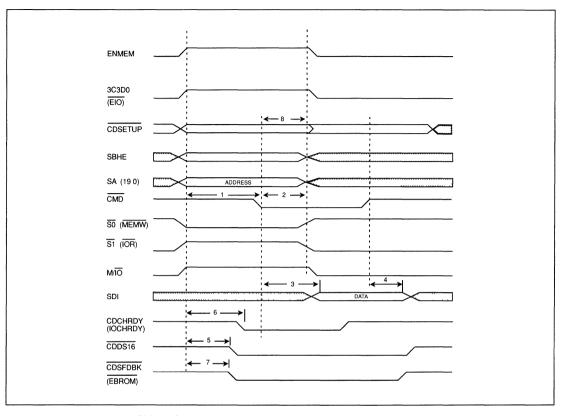
FIGURE C-7. MEMORY WRITE-MICRO CHANNEL MODE
