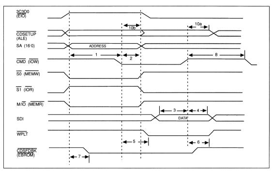
FIGURE C-5. I/O WRITE-MICRO CHANNEL MODE
