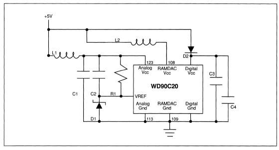
FIGURE 4-2. POWER DISTRIBUTION FOR WD90C20
