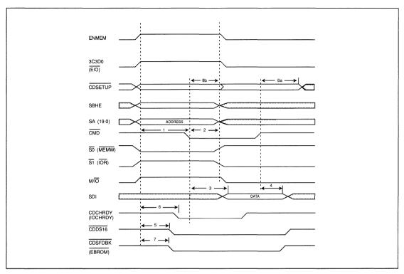
FIGURE C-7. MEMORY WRITE-MICRO CHANNEL MODE
