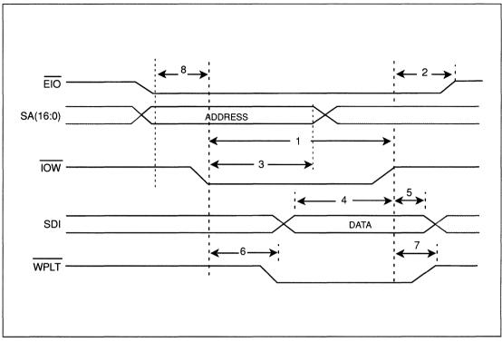
FIGURE C-1. I/O WRITE-AT MODE
