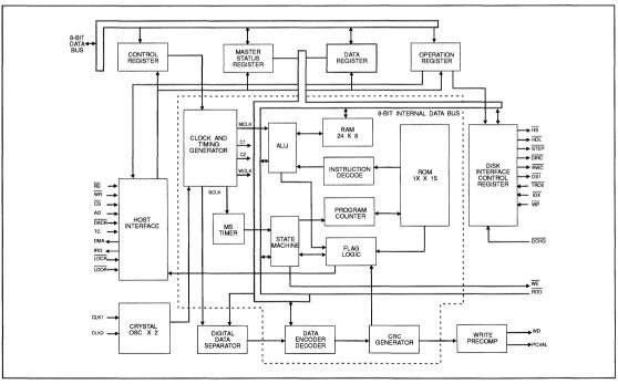
FIGURE 2-2. FLOPPY DISK CONTROLLER BLOCK DIAGRAM
