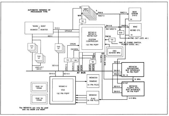
FIGURE 2-1. SYSTEM LEVEL FUNCTIONAL BLOCK DIAGRAM
