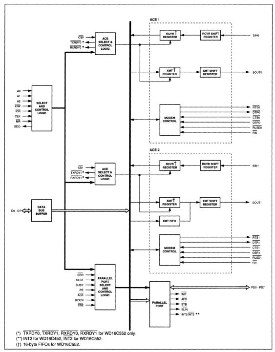
FIGURE 1-2. WD16C452/WD16C552 BLOCK DIAGRAM
