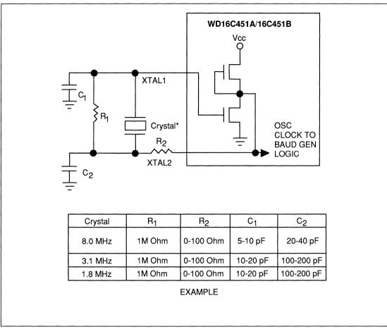
FIGURE 6-2. TYPICAL CRYSTAL OSCILLATOR NETWORK
