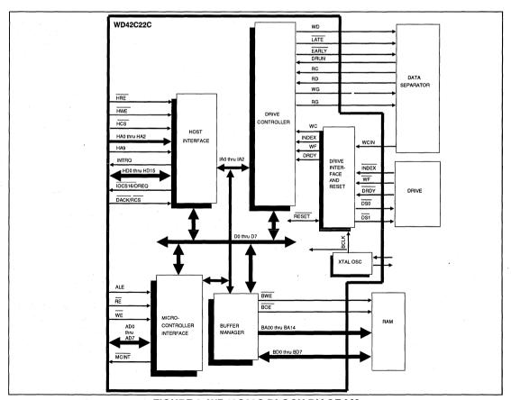
FIGURE 2. WD42C22C BLOCK DIAGRAM
