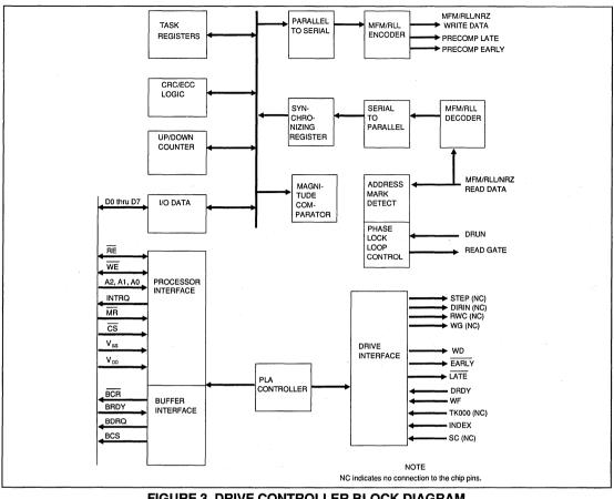
FIGURE 3. DRIVE CONTROLLER BLOCK DIAGRAM
