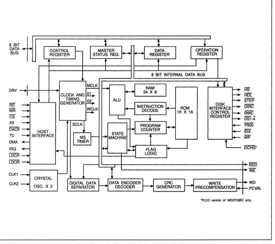
FIGURE 3-1. WD37C65C BLOCK DIAGRAM
