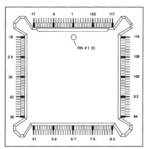
FIGURE 4-1. 132-PIN JEDEC PACKAGE
