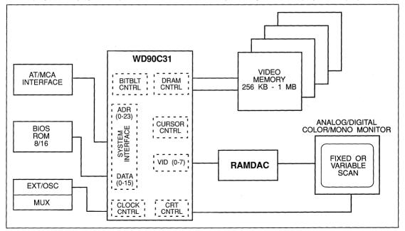
FIGURE 2-1. SYSTEM BLOCK DIAGRAM
