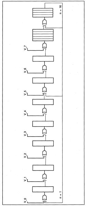
FIGURE 14-1. LINEAR FEEDBACK SHIFT REGISTER
