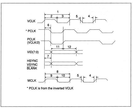
FIGURE 6-2. CLOCK AND VIDEO TIMING
