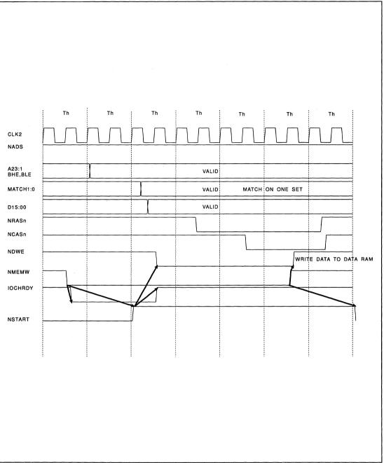
FIGURE 13-65. DMA/MASTERMEMORY WRITE HIT CYCLE
