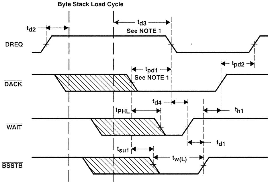
**Figure 7-9. DMA Read – Byte Stack, Nondemand Mode**
