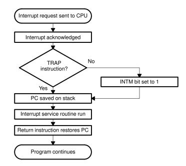
Figure 5–10. Nonmaskable Interrupt Operation Flow Chart
