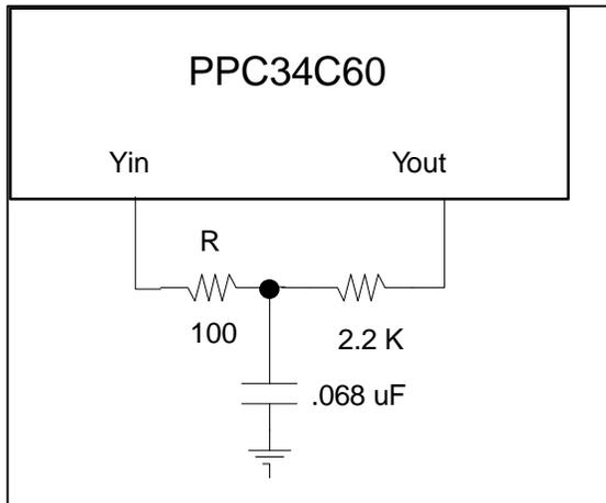
FIGURE 10 - SUGGESTED 32 KHz OSCILLATOR CIRCUIT
