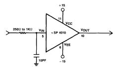
OPTIMIZE FOR LARGE SIGNAL SETTLING
