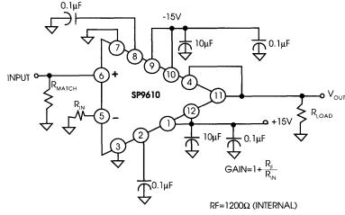
FIGURE 3. SP9610 NONINVERTING OPERATION
