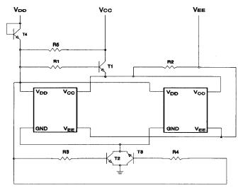
R1-R2-R3-R4- 3.3K Ohms R5= 15K Ohms T1-T2-T3-T4- 2N2222A
