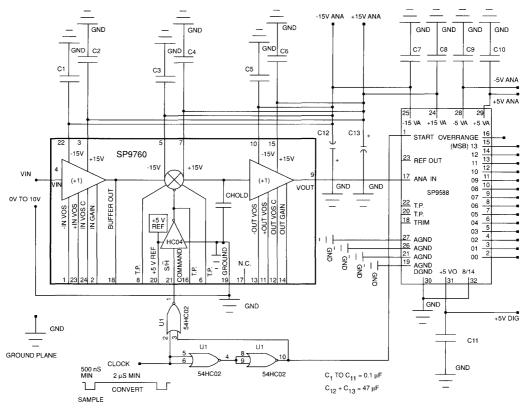
FIGURE 3 OV TO 10V UNIPOLAR DATA ACQUISITION SYSTEM
