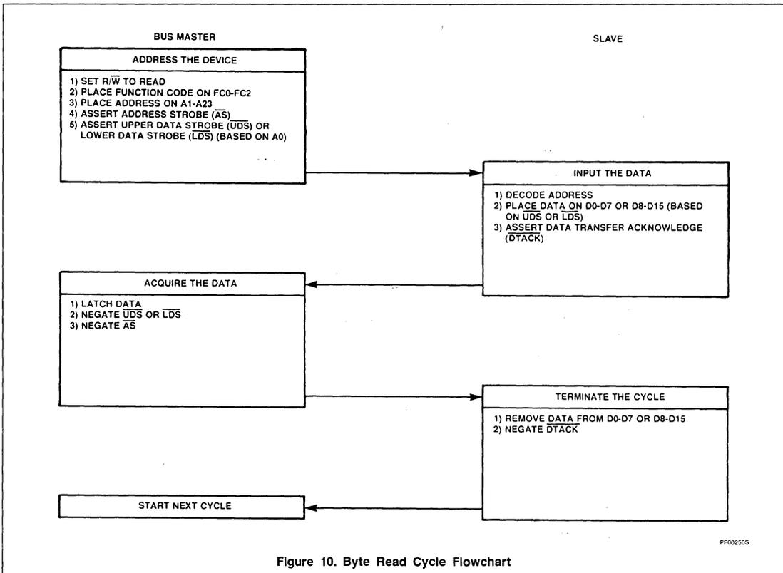
Figure 10. Byte Read Cycle Flowchart
