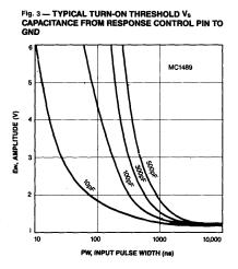
Fig. 4 — TYPICAL TURN-ON THRESHOLD  $V_{\rm S}$  CAPACITANCE FROM RESPONSE CONTROL PIN TO GND
