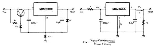
$V_0 = V_{XX} + V_{Z1}$
