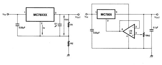
$I_{R1} \ge 5I_d$  $V_0 = V_{XX} (1 + R_2/R_1) + I_d R_2$
