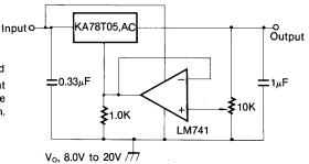
$V_{IN} - V_0 \ge 2.5V$
