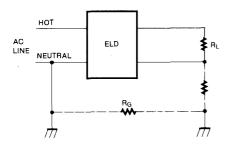
FIG. 5 GROUNDED NEUTRAL FAULT
