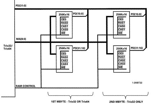
Figure 7-1. 1-MByte Trio32/64 - 2 MByte Trio32 Memory
