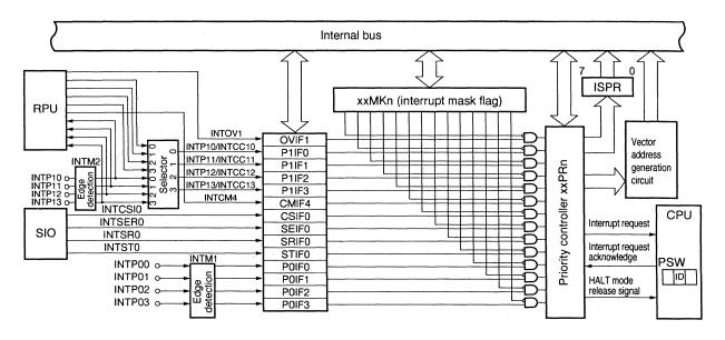
Figure 5-4. Maskable Interrupt Block Diagram
