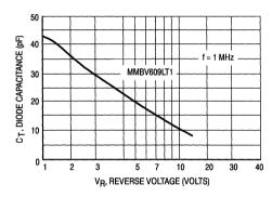
Figure 6. Diode Capacitance Each Die
