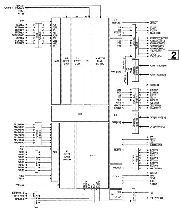
Figure 14. MC68F333 Block Diagram
