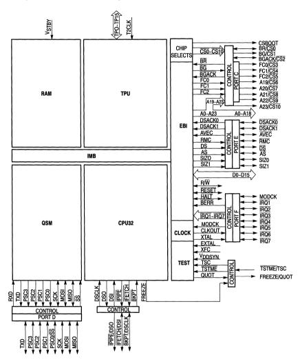
Figure 13. MC68332 Block Diagram
