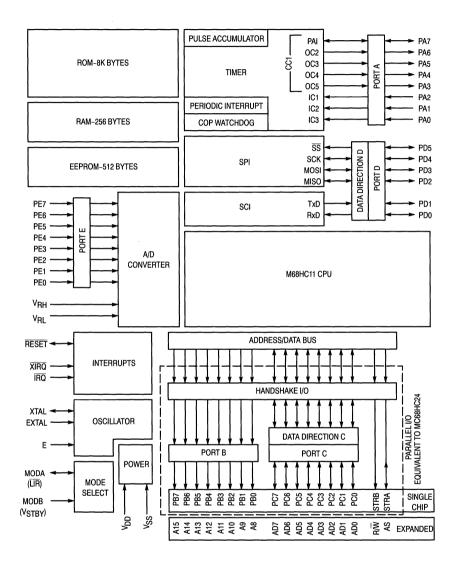
Figure 6. MC68HC11A8 Block Diagram
