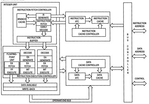
Figure 1. MC68060 Block Diagram
