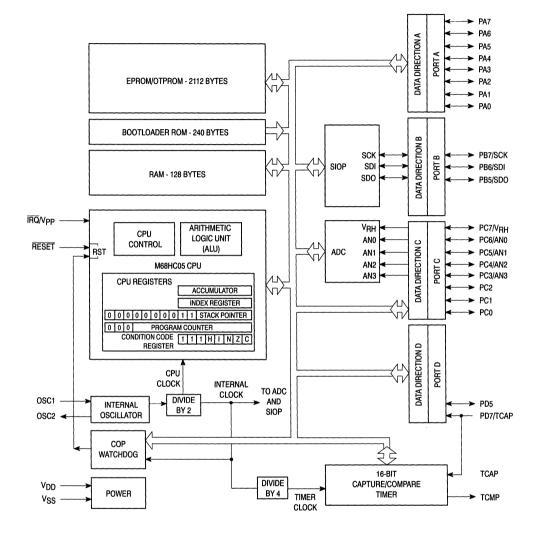
Figure 4. MC68HC705P9 Block Diagram
