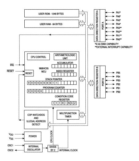
Figure 3. MC68HC05J1A Block Diagram
