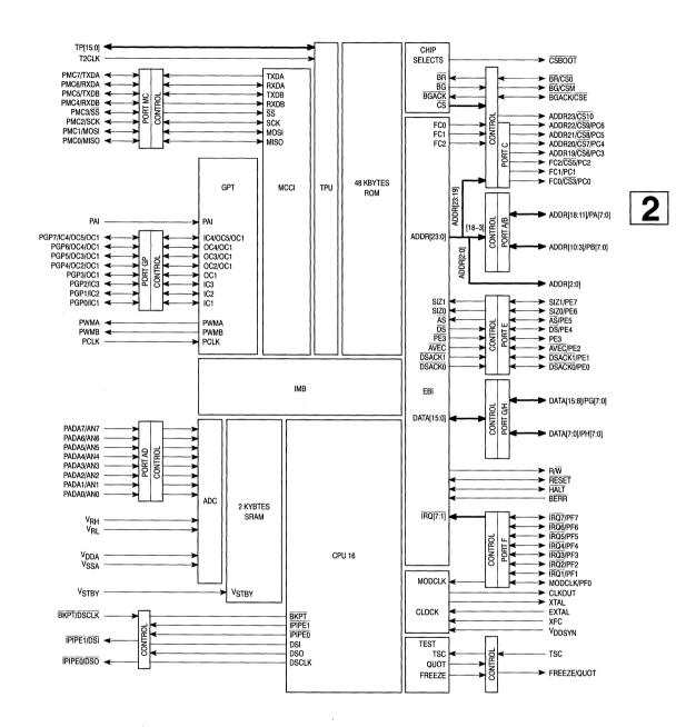
Figure 11. MC68HC16Y1 Block Diagram
