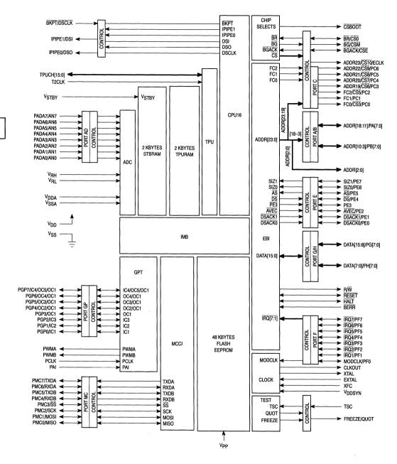
Figure 12. MC68HC916Y1 Block Diagram
