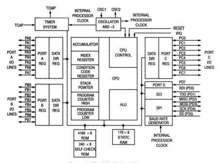
Figure 1. MC68HC05C4 Block Diagram
