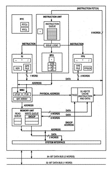
Figure 1. MPC601 Block Diagram
