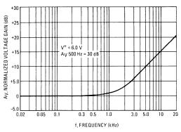
FIGURE 8 – PLAYBACK VOLTAGE GAIN versus FREQUENCY
