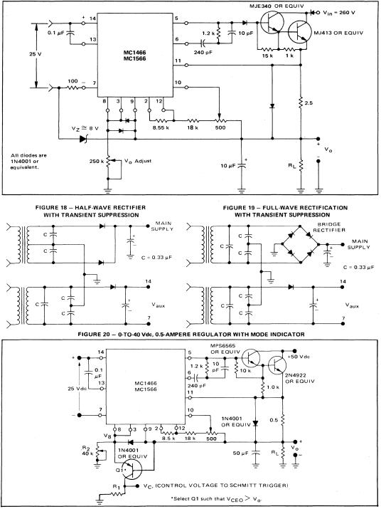
FIGURE 17 - A 0-TO-250 VOLT, 0.1-AMPERE REGULATOR
