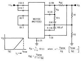
FIGURE 19 – +5 V, 1-AMPERE HIGH EFFICIENCY REGULATOR
