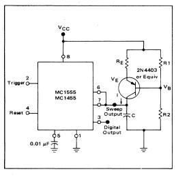
FIGURE 21 -- LINEAR VOLTAGE RAMP WAVEFORMS
