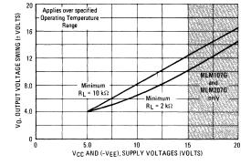
FIGURE 2 - MINIMUM OUTPUT VOLTAGE SWING
