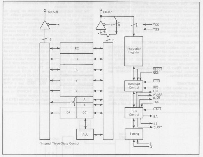
FIGURE 4 - MC6809E Block Diagram
