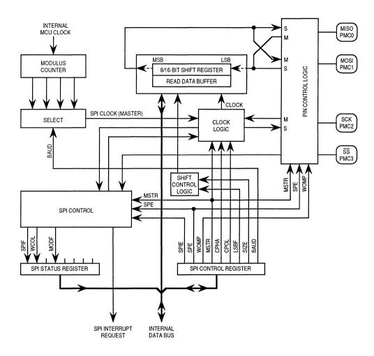
Figure 4-1. SPI Submodule Block Diagram
