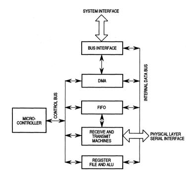
Figure 1-2. MC68605 Block Diagram
