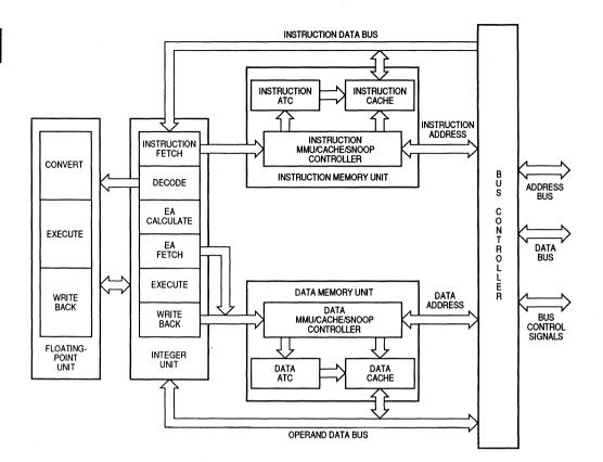
Figure 1-1. MC68040 Block Diagram
