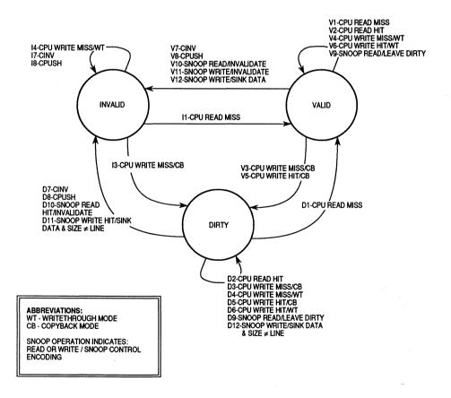
Figure 7-6. Data-Cache-Line State Diagram
