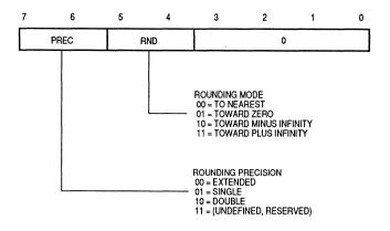
Figure 2-4. FPCR Mode Control Byte
