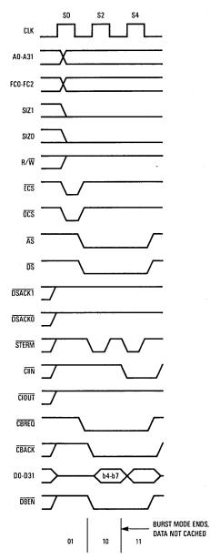
VALUE OF A3:A2 INCREMENTED BY THE SYSTEM HARDWARE
