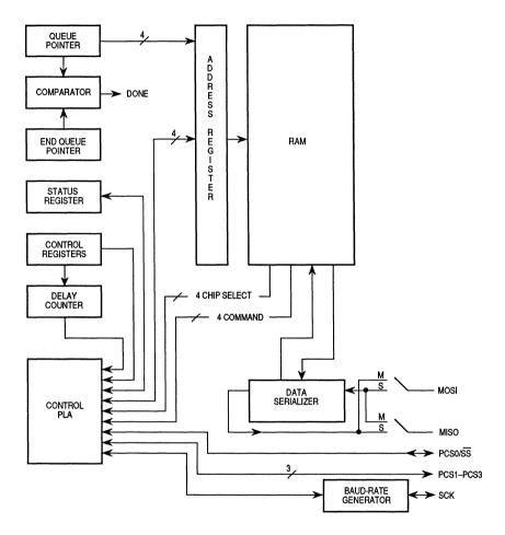
Figure 5-10. QSPI Submodule Diagram
