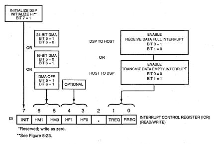
Figure 5-21 (d) HI Initialization–Host Side, DMA Mode
