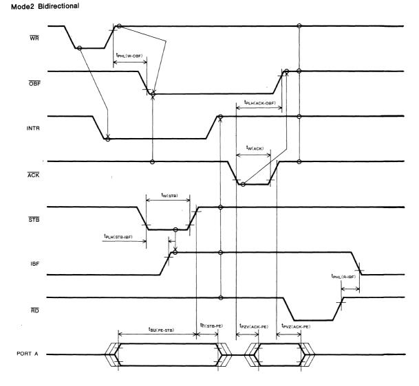
Note 13 INTR=IBF  $\cdot \overline{MASK} \cdot \overline{STB} \cdot \overline{RD} + \overline{OBF} \cdot \overline{MASK} \cdot \overline{ACK} \cdot \overline{WR}$
