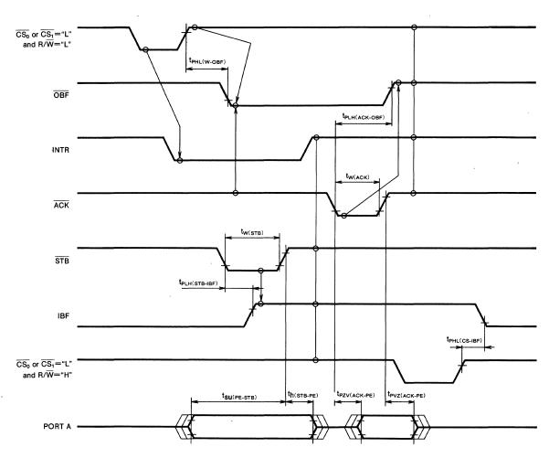
Note 5 :  $INTR = IBF \cdot \overline{MASK} \cdot \overline{STB} \cdot \overline{CS_0}$  or  $\overline{CS_1} + \overline{OBF} \cdot \overline{MASK} \cdot \overline{ACK} \cdot R/\overline{W}$
