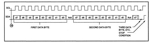
Fig. 3B Byte Write Sequence
