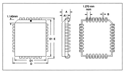
Figure 4.23 32 pin PLCC J-bend package dimensions
