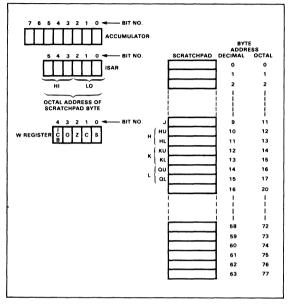
Fig. 2-8. 3850 CPU Programmable Registers
