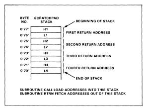
Fig. 7-3. Scratchpad Stack
