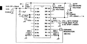
Figure 16. Transmit Gain
