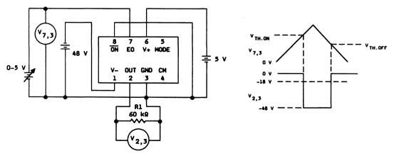
**Figure 7. EO Threshold Tests**
