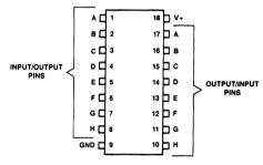
COMPLEMENTARY INPUT/OUTPUT LEADS MAY BE INTERCHANGED FOR BIDIRECTIONAL OPERATION.
