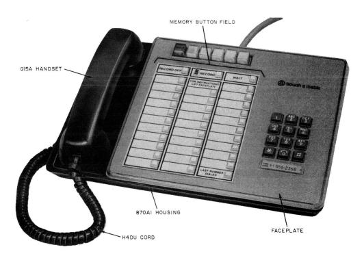
Fig. 1—2872A1M or 2872A2M Telephone Set
